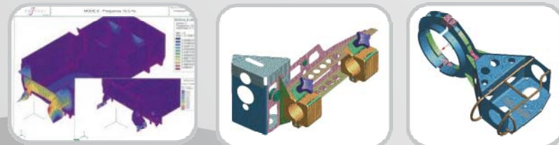
Tenue aux vibrations d'une cuve de transformateur de traction (TGV-France)
